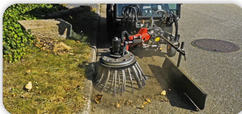
Brosse à mauvaises herbes avec aspiration
